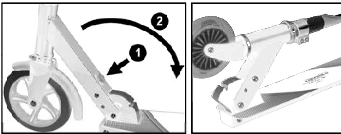
La roue avant et le guidon sont articulés par une charnière à l'avant du plateau. Pour ouvrir le scooter dans sa position de conduite, appuyez simplement sur le bouton rouge et soulevez la colonne du guidon. Lorsque le guidon et la roue avant sont dans la bonne position de conduite, le mécanisme de pliage s'enclenche et se verrouille. Pour replier le scooter à plat, appuyez à nouveau sur le bouton et déplacez la colonne vers le bas, jusqu'à ce que le mécanisme de verrouillage s'enclenche.
