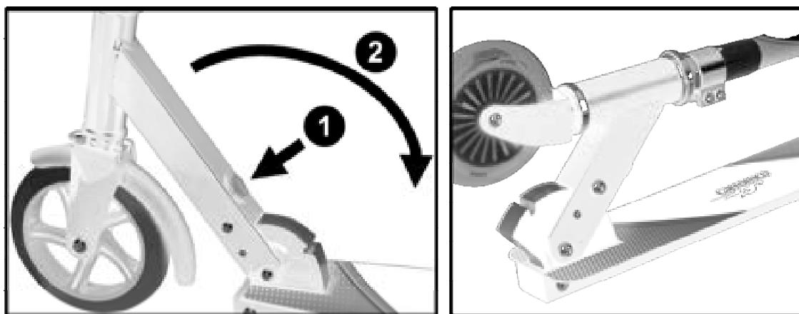
Die Lenkstangenkonstruktion mit dem Vorderrad ist auf der Vorderseite der Stehplatte angebracht. Um den Scooter in seine Fahrposition zu bringen, drücken Sie einfach den roten Knopf und heben Sie die Lenkstange an, bis der Mechanismus einrastet. Um den Roller flach zusammenzuklappen, drücken Sie den roten Knopf und senken Sie die Lenkstange auf das Deck bis der Mechanismus einrastet.
