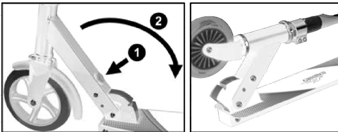
Het voorwiel- en stuurgedeelte zijn via een scharnier aan de voetplaat vastgemaakt. Om de scooter in de rijpositie te zetten, drukt u eenvoudig op de rode knop en tilt u de stuurkolom omhoog. Wanneer het stuur en het voorwiel in de juiste rijpositie zijn, zal het vouwmechanisme vastklikken en vergrendelen. Om de scooter plat te vouwen, drukt u nogmaals op de knop en verplaats u de kolom omlaag totdat het vergrendelingsmechanisme klikt.
