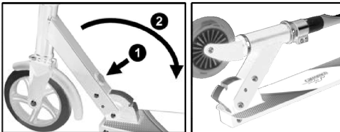
La ruota anteriore e il manubrio sono fissati da un meccanismo a cerniera sul davanti della tavola. Per aprire lo scooter nella sua posizione di guida, premere semplicemente il pulsante rosso e sollevare la colonna del manubrio verso l'alto. Quando i manubri e il gruppo ruota anteriore sono in posizione di guida corretta, il
